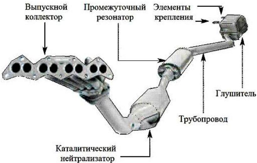
Рис. 2.1. Система выпуска отработавших газов автомобиля
