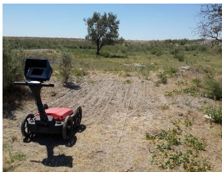
Рисунок 2. – Тестовые исследования по определению влажности грунта
