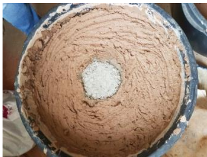
Рисунок 2. – Опытный фрагмент грунта с армодризирующим элементом внутри
