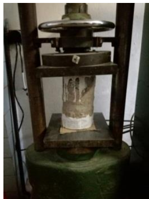
Рисунок 4. – Образец, помещенный в гидравлический пресс
