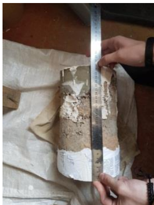
Рисунок 3. – Образец класса С8/10, подготовленный к испытанию. Вид сбоку
