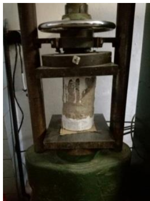
Рисунок 4. – Образец, помещенный в гидравлический пресс
