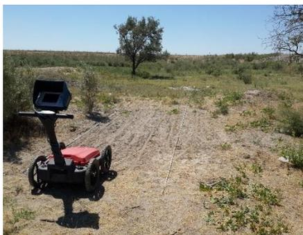
**Рисунок 2. – Тестовые исследования по определению влажности грунта**
