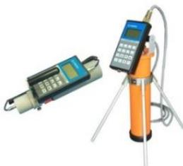
**Рисунок 1. - Спектрометр МКС-АТ6101Д**
