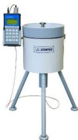
**Рисунок 2. - Гамма-радиометр спектрометрического типа РГК-АТ1320**
