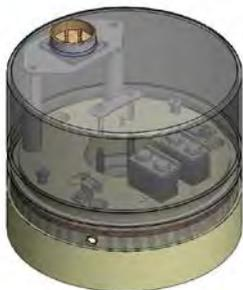
Рисунок – Реле пневматическое общеклиматического исполнения
