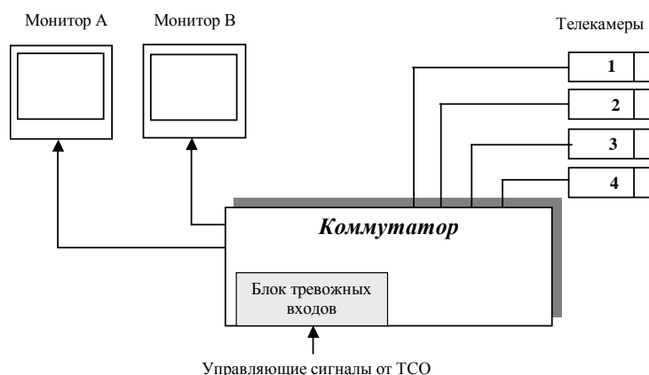
Рис. 27. Схема построения системы видеонаблюдения на основе коммутатора с блоком тревожных входов
