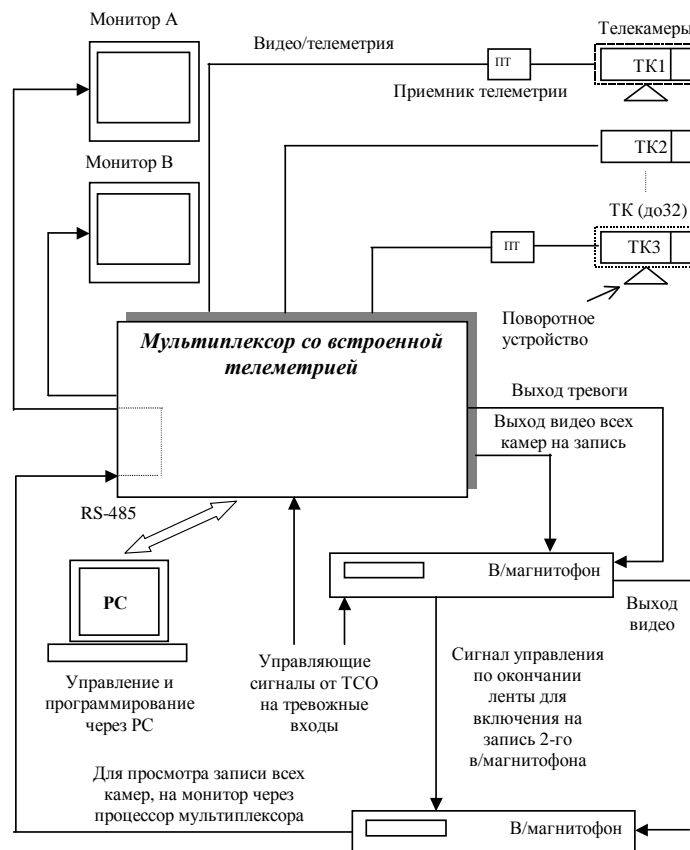
Рис. 29. Схема построения системы видеонаблюдения на основе мультимплексора со встроенной телеметрией и двух видеоманитфонов
