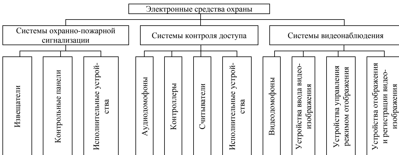
Рис. 5. Состав электронных средств охраны
