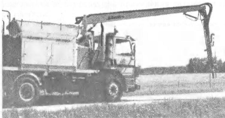
Рис. 5.23. Технологический комплекс получения холодных смесей по инъекционно-струйной технологии.
