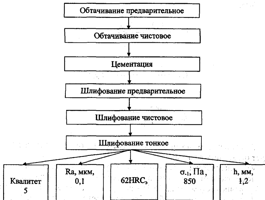
Рис. 2.15. 1. Схема комплекса способов и результатов обработки наружной цилиндрической поверхности
