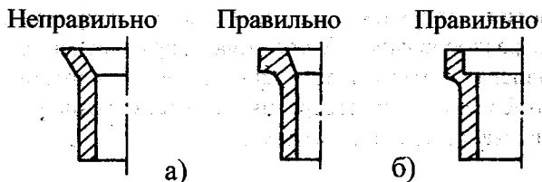
Рис. 3.8.10. Конструкции торцовых поверхностей
