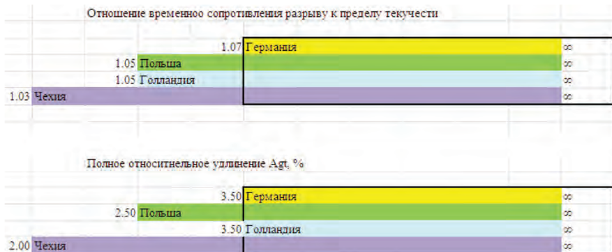
Рис. 2. Пример объединения механических требований для арматуры унифицированного класса У4 диаметром 6,0 мм
