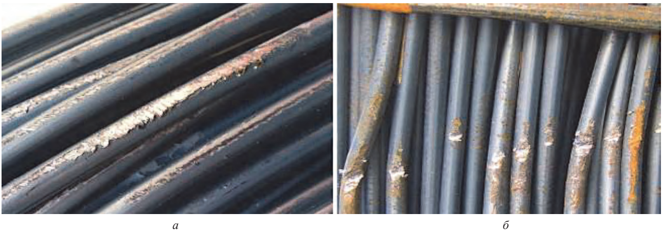
Рис. 2. Дефекты транспортировки бунтов катанки диаметром 5,5 мм
