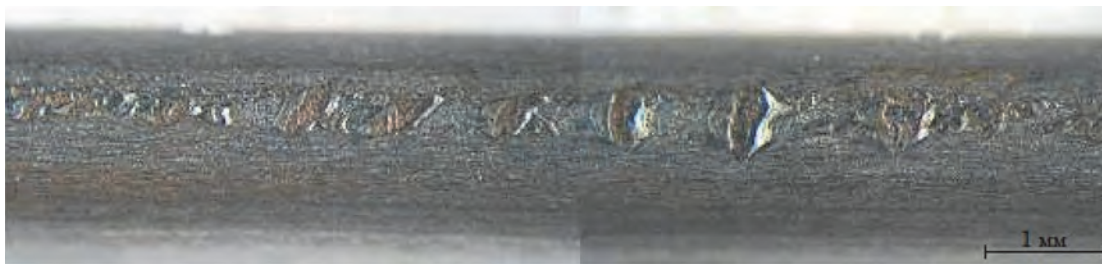
Рис. 3. Поверхностные дефекты на проволоке диаметром 1,97 мм протяженностью ~3 см, изготовленной из катанки 5,5 мм, марки 80 с незначительным дефектом увязки протяженностью ~10 мм
