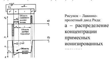
В настоящее время лавинно-пролетный диод является одним из самых мощных твердотельных источников СВЧ-излучения. ЛПД могут генерировать в непрерывном режиме наибольшую мощность в диапазоне частот, соответствующих миллиметровым длинам волн (свыше 30 ГГц).
