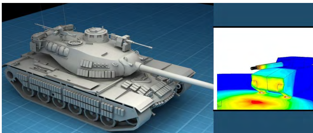
Рисунок 4 - Моделирование воздействия ударной волны на корпус танка в ПК LS-DYNA
