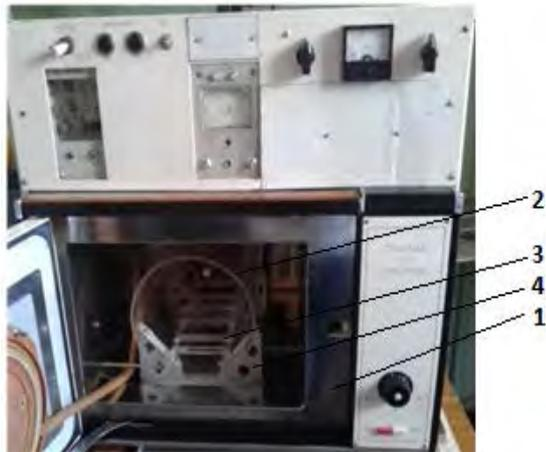
Рисунок 1 – СВЧ плазмотрон резонаторного типа
