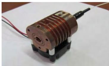
Рисунок 2 – OEM импульсный лазер на основе кристалла Er,Yb:GAB
