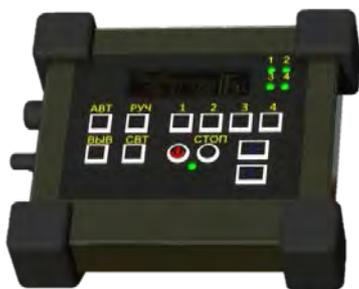
Рисунок 2 – Пульт дистанционного управления системы горизонтирования
