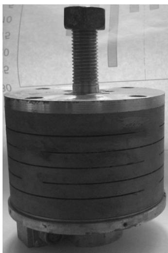
Рисунок 3 – Весоизмерительная опора (защитный кожух снят)
