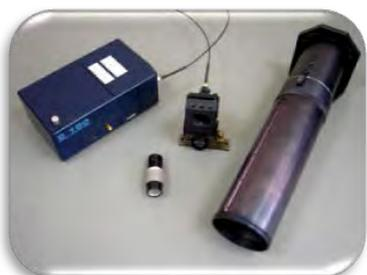
Рисунок 2 – Блок регистрации спектров оптического излучения
