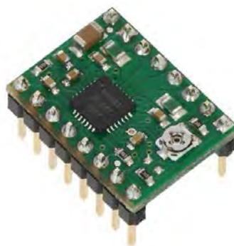
Рисунок 6 – Мотор-драйвер шагового двигателя A4988 (EC141225)
