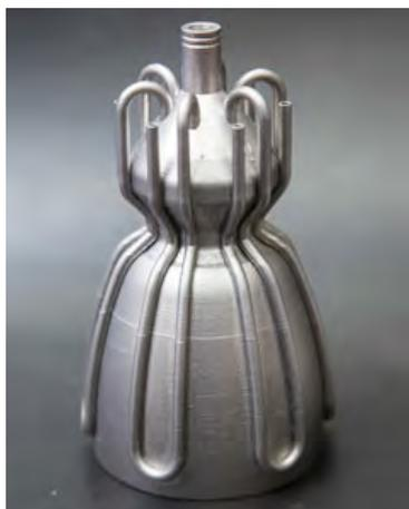
Рисунок 4 – Сопло и камера сгорания малогабаритного ЖРД, полученная АТ из жаропрочного сплава Inconel 718 с каналами охлаждения жидким топливом на поверхности сопла и камеры сгорания [8]
