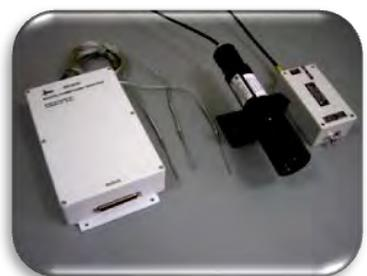
Рисунок 3 – Блок регистрации температур
