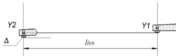
Рисунок 2 – Перемещение наконечника по длине контролируемой детали
