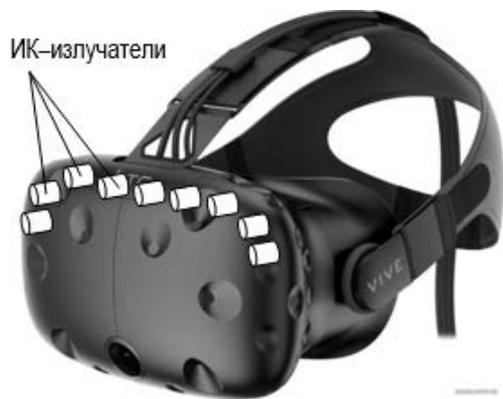
Рисунок 4 – Схема размещения ИК-излучателей на очках HTC Vive
