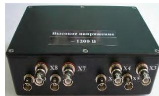
Рисунок 5 – Источник питания высоковольтный
