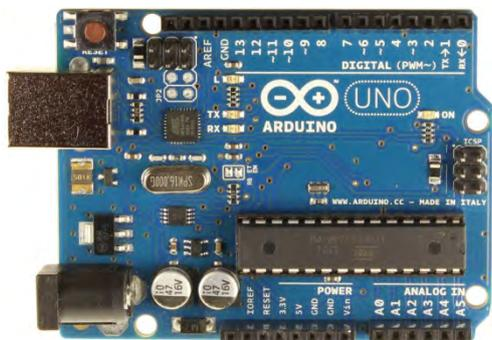
Рисунок 4 – Плата контроллера Arduino UNO R3 (FZ0038)
