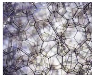
Рисунок 1 – Форма ячеек пены ( $\times 10$ )
