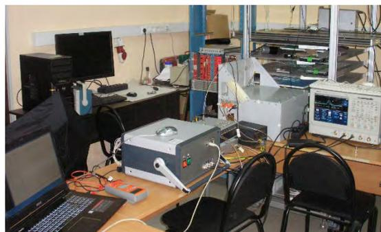
Рисунок 6 – Проведение испытаний блоков многослойной сцинтилляционной детекторной системы
