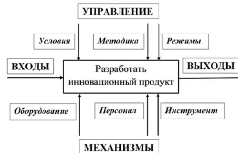
Рисунок 1 – Процесс разработки инновационного продукта в нотации IDEF0
