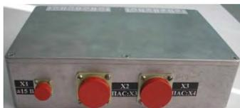
Рисунок 2 – Блок дискриминаторов
