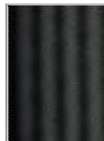
Рисунок 5 – Изображение графитовых стержней в обратнорассеянном рентгеновском излучении
