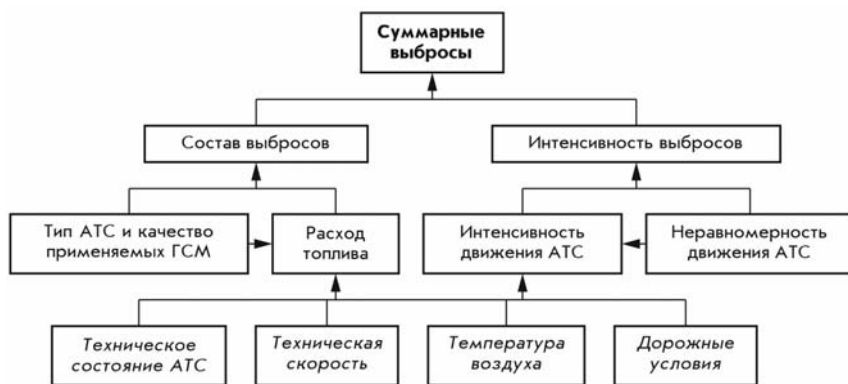
Рис. 1.1. Схема формирования выбросов
