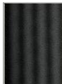
Рисунок 5 – Изображение графитовых стержней в обратнорассеянном рентгеновском излучении
