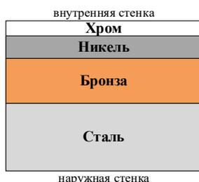
Рисунок 1 – Структура многослойной стенки камеры сгорания ЖРД
