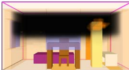
Рисунок 2 – Вид комнаты на 195-й секунде пожара с источником мощностью 90 кВт на полу (а) и высоте 2.2 м (б)
