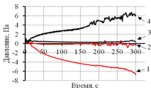
Рисунок 8 – Зависимости изменения давления воздуха в центре комнаты от времени на высоте 0,1 (1, 3) и 2,6 м (2, 4) с вентиляционным отверстием от уровня пола (1, 2), потолка (3, 4)
