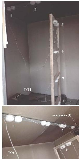
Рисунок 1 – Размещение системы контроля температуры и оптических характеристик в среды на основе адресно-аналоговой системы пожарной сигнализации «Болид»
