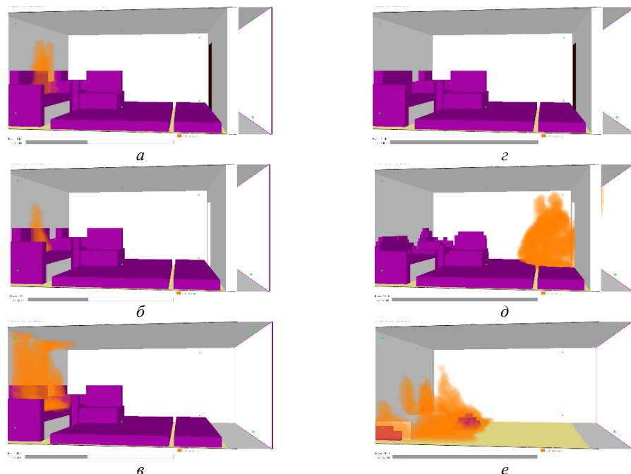
Рисунок 5 – Картинки распространения пламенного горения на 500-й (а–с) и 1200-й секунде (д–е) пожаров в закрытой комнате (а, д), с естественной вентиляцией через открытую дверь (б, д) и через проем в стене (в, е)
