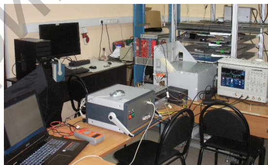
Рисунок 6 – Проведение испытаний блоков многослойной сцинтилляционной детекторной системы
