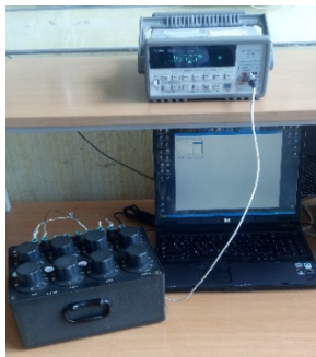
Рисунок 4 – Фотография автоматизированного рабочего места поверителя при поверке ММЭС
