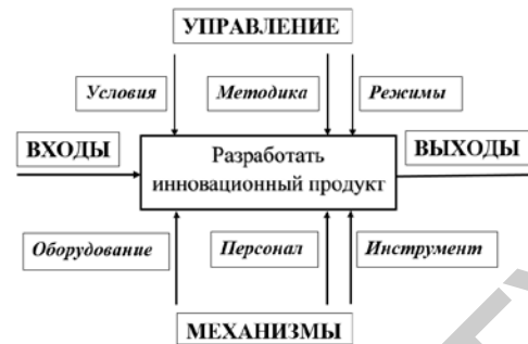
Рисунок 1 – Процесс разработки инновационного продукта в нотации IDEF0
