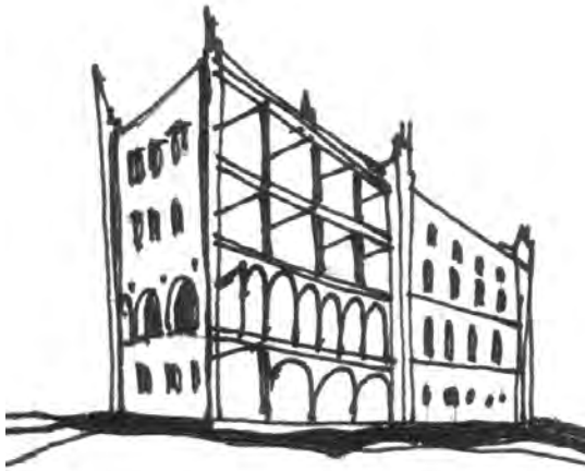
Рис. 1.3.4. Схема модифицированной разновидности промышленного здания с ярусным построением пространства
