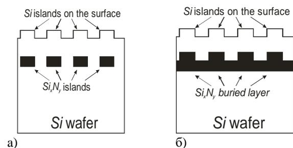
Рисунок 3 – Модельное представление образования островкового слоя на поверхности и в объеме кремниевой пластины
