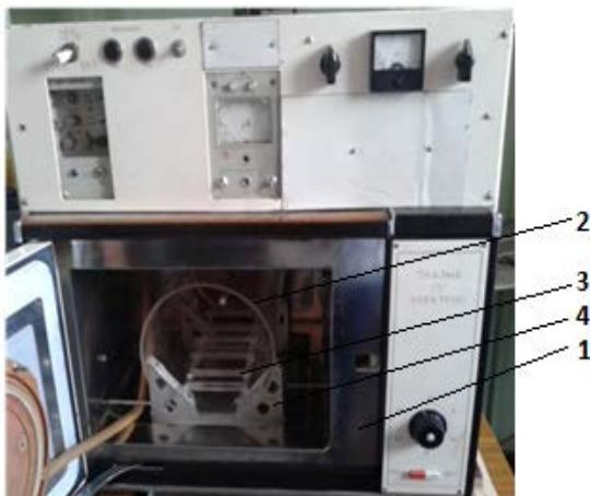
Рисунок 1 – СВЧ плазмотрон резонаторного типа
