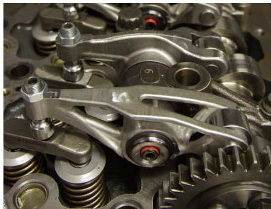
Рисунок 10 – Стальной рычаг привода клапанов дизельного двигателя Рено DT-15 Euro 6, произведенный с помощью АТ (на переднем плане) в сравнении с традиционной конструкцией (на заднем плане) [11]
