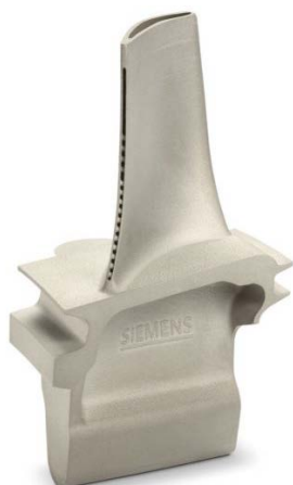
Рисунок 5 – Лопатка стационарного ТРД, полученная АТ из жаропрочного сплава Inconel 725 с каналами воздушного охлаждения в теле лопатки [8]
