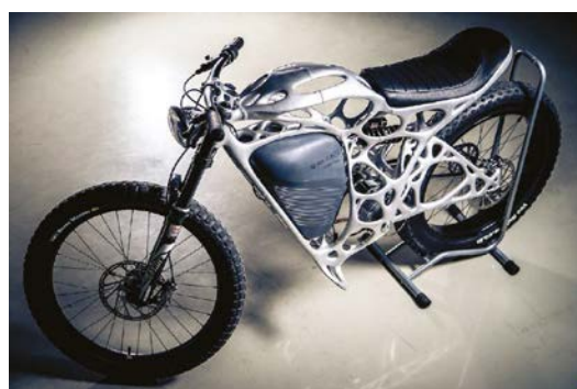
Рисунок 2 – Био-дизайн рамы легкого мотоцикла, полученной АТ из титанового сплава [6]
