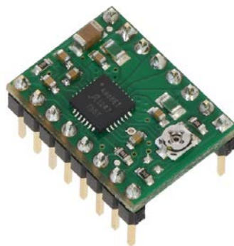
Рисунок 6 – Мотор-драйвер шагового двигателя A4988 (EC141225)
