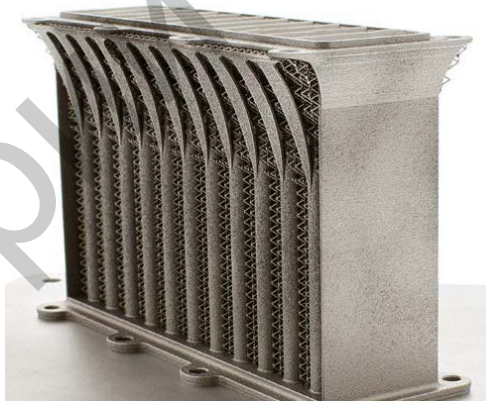
Рисунок 7 – Интеркуллер двигателя спортивного автомобиля [7], полученный АТ из алюминиевого сплава
