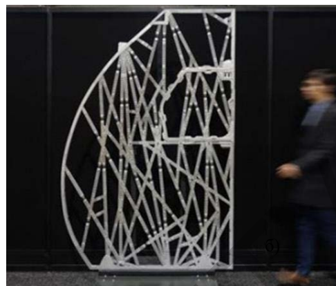
Рисунок 1 – Био-дизайн конструкции переборки лайнера Airbus A320 [5], полученной АТ из титанового сплава
