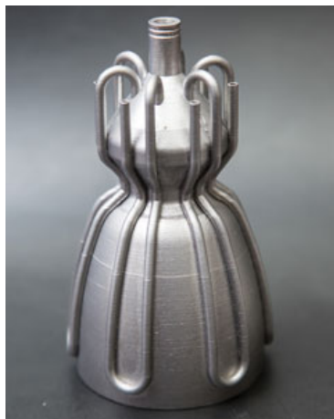
Рисунок 4 – Сопло и камера сгорания малогабаритного ЖРД, полученная АТ из жаропрочного сплава Inconel 718 с каналами охлаждения жидким топливом на поверхности сопла и камеры сгорания [8]
