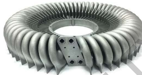
Рисунок 6 – Спиральный теплообменник [7], полученный АТ из жаропрочного сплава
