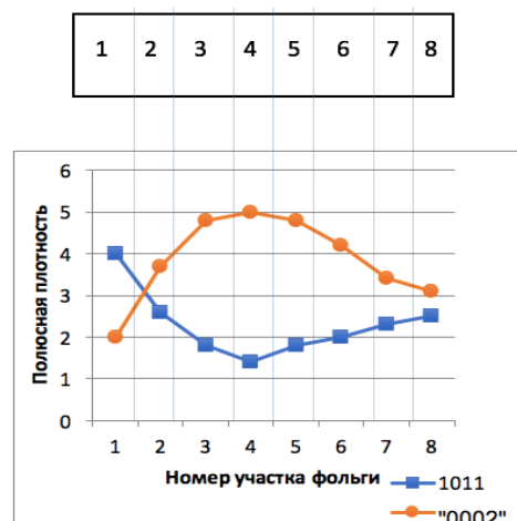
Рисунок 2 – Схема расположения участков фольги (а) и зависимость полюсной плотности дифракционных линий 0002 и 10\bar{1}1 от расстояния вдоль фольги (б)
