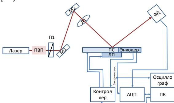
Рисунок 1 – Макет устройства для детектирования дефектов: ПВП – полуволновая пластинка, П1 – линейный поляризатор, М1,2 – зеркала, Л1 – линза, ПС – поворотный стол, ЛТ – линейный транслятор, ПК – персональный компьютер, ФД – фотодиод, АЦП – аналого-цифровой преобразователь
