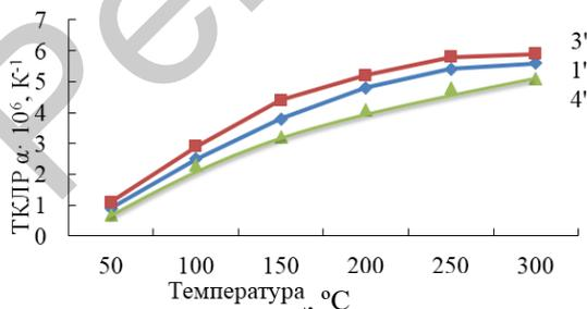
Рисунок 2 – Зависимость ТКЛР опытных образцов составов №1', 3', 4', обожженных при температуре  $1325^\circ C$ , от температуры нагрева
