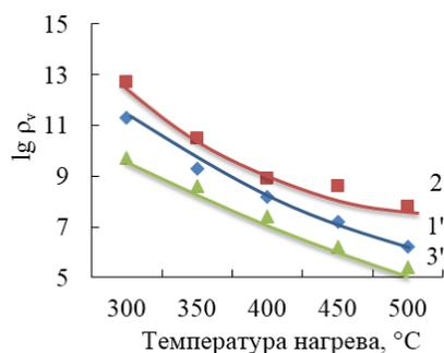
Рисунок 3 – Зависимость логарифма удельного объемного сопротивления опытных образцов от температуры нагрева
