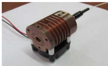
Рисунок 2 – OEM импульсный лазер на основе кристалла Er,Yb:GAB
