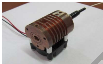
Рисунок 2 – OEM импульсный лазер на основе кристалла Er,Yb:GAB
