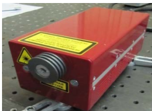
Рисунок 1 – Внешний вид Er,Yb:GAB лазера работающего в непрерывном режиме
