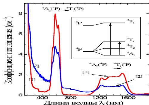
Рисунок 3 – Спектр поглощения керамики  $\text{Co}^{2+}:\text{MgAl}_2\text{O}_4$
