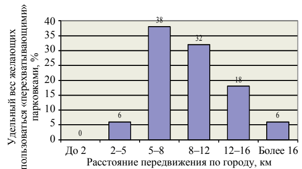
Рис. 7. Зависимость спроса на «перехватывающие» парковки от расстояния передвижения по городу
