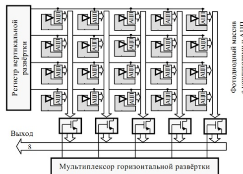
Рисунок 3 – КМОП сенсор с активным цифровым пикселом
