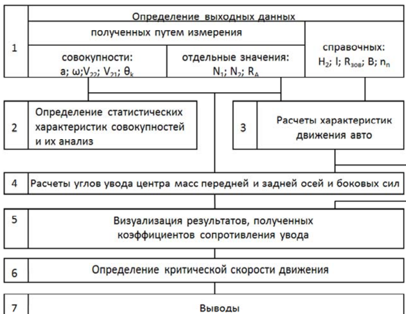
Рисунок 3 – Блок-схема алгоритма исследования показателей КУД автомобилей
