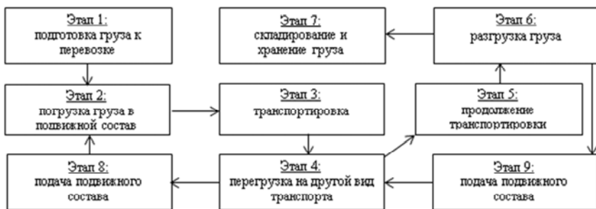
Рисунок 2 – Схема перевозки грузов различными видами транспорта
