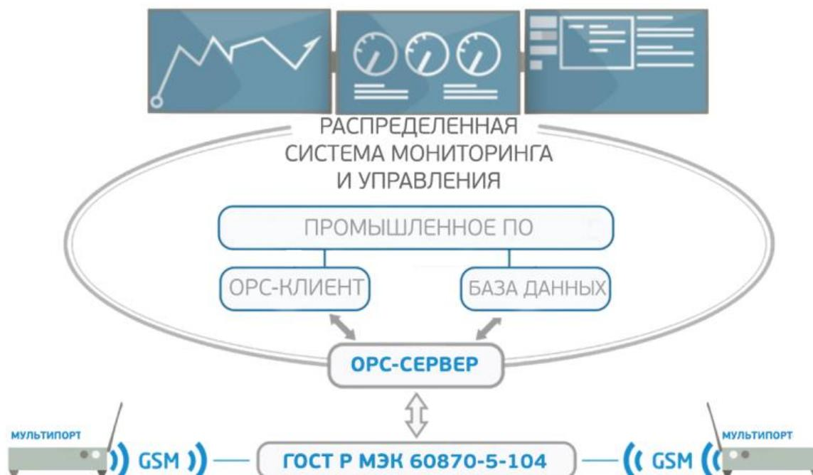
Рисунок 1 – Структурная схема системы сбора и передачи данных на базе УСПД
