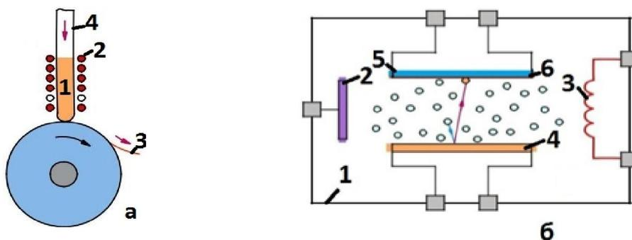
Рисунок 1. Схема устройства для получения аморфных сплавов закалкой из жидкого состояния (а) ионно-плазменным распылением металлов из сплавов (б)
