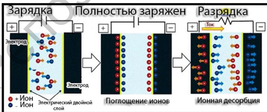
Рисунок 2. Процесс зарядки/разрядки ионистора
