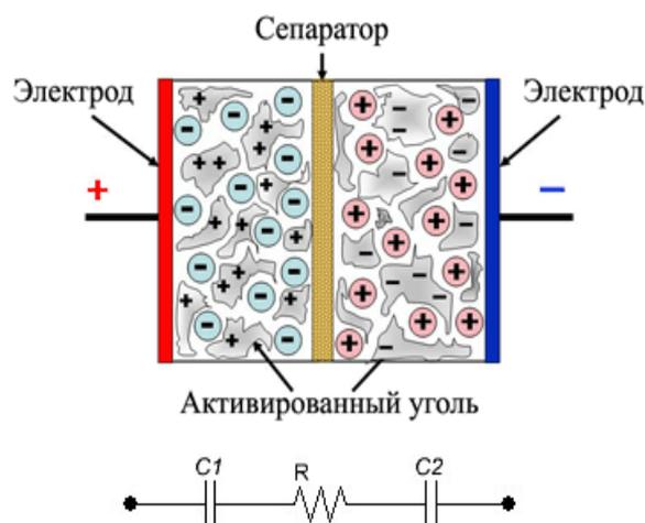
Рисунок 1. Устройство ионистора
