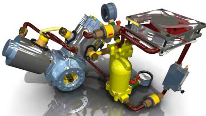
Рисунок 1 – Система охлаждения компрессора АК150МКВ на основе использования колебаний давления газа на нагнетании
