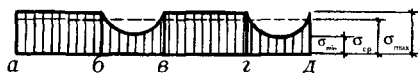
Рис. 7.9. Распределение напряжений по периметру примыкания прямоугольной трубы раскоса к поясной трубе (расположение точек а, б, в, г, см. рис. 7.6 г)
