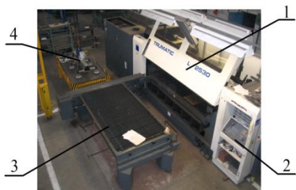
1 – задвижная крышка; 2 – панель управления; 3 – паллета; 4 – устройство подачи листов
