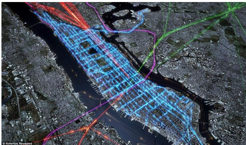
Рисунок 5 – Коммьютинг на Манхеттене (Паромы показаны оранжевым цветом, линии пригородных поездов – зеленым, железнодорожные – фиолетовым и красным; автобусные маршруты – голубым)
