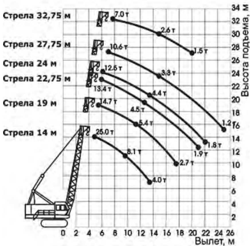
Рисунок 9.6. – Схема основного подъема крана ДЭК-251
