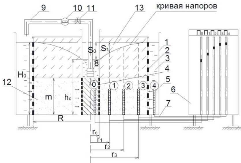
Рис. 3. Схема лабораторной установки: модель совершенной водозаборной скважины в напорном пласте:
