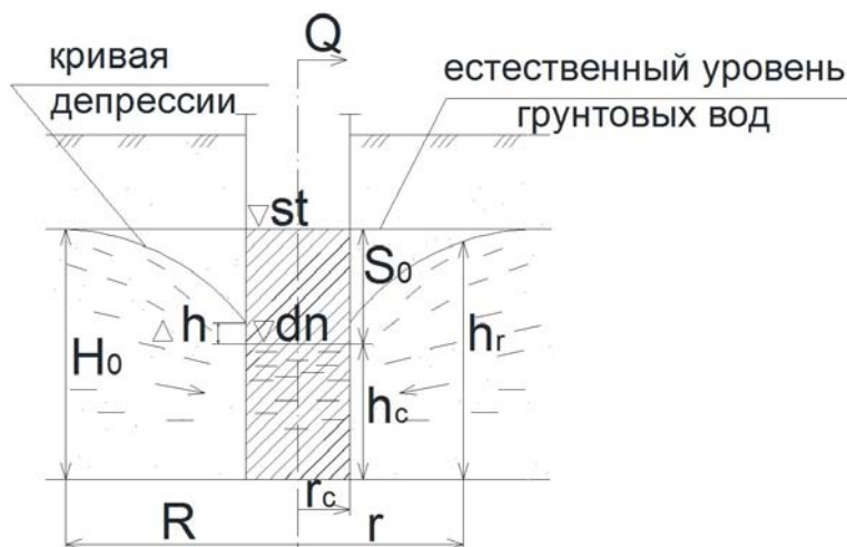
Рис. 1. Схема притока воды к совершенным скважинам в безнапорном пласте
