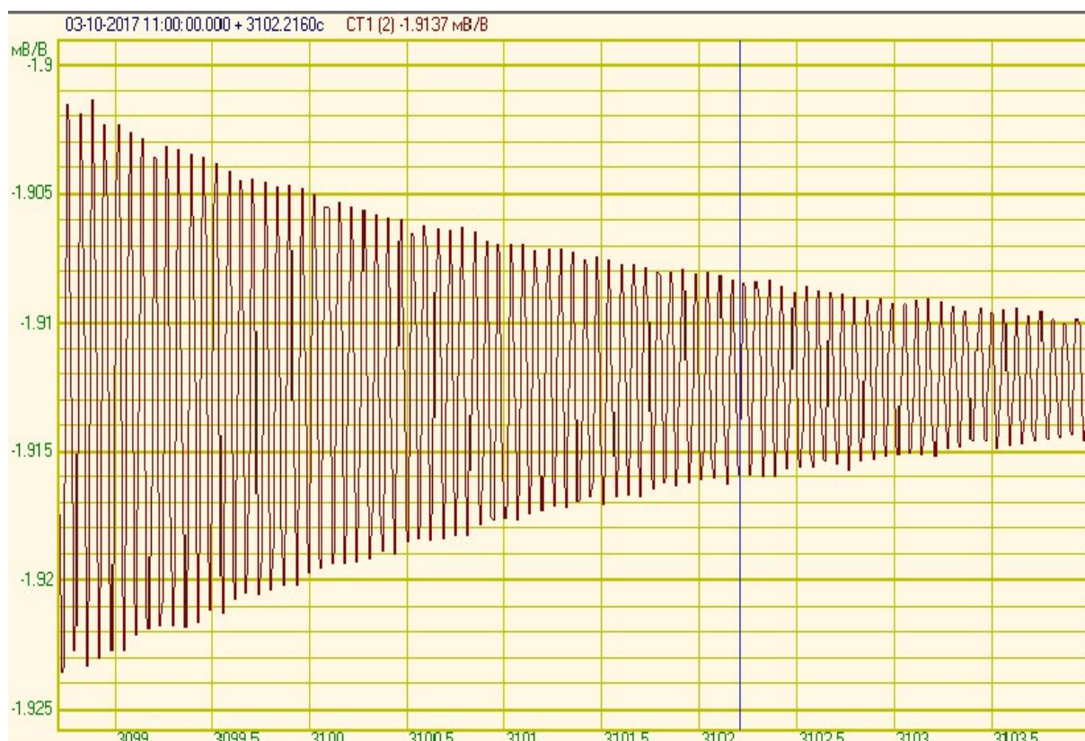
Рисунок 3 – Осциллограмма свободных затухающих колебаний балки при импульсной нагрузке
