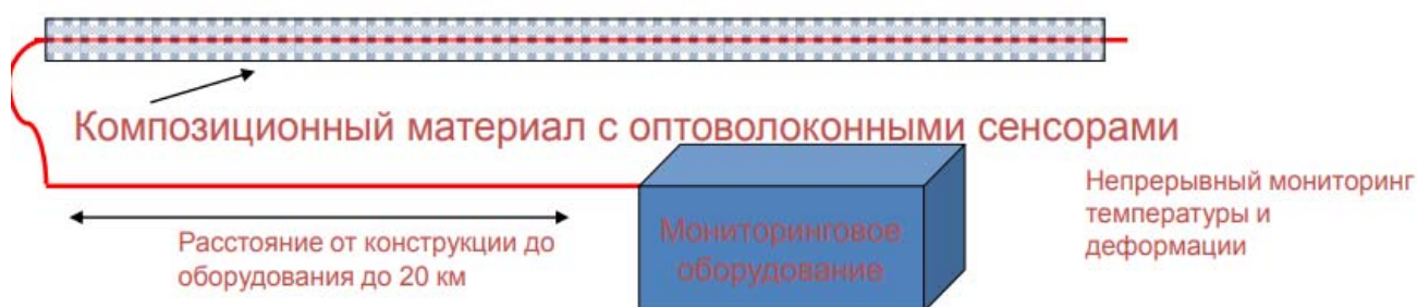
Рисунок 1 – Оптоволоконные системы мониторинга
