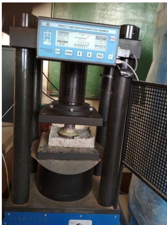
Рисунок 2 – Испытание образца на гидравлическом прессе ПГМ-1000МГ4
