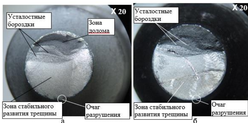
Рисунок 2 – Характер изломов образцов после проведения испытаний для стали 45: а – образец с цинковым диффузионным слоем; б – образец без защитного покрытия
