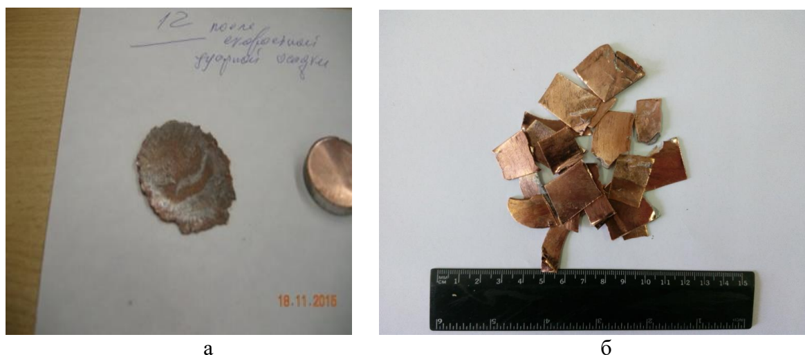
Рисунок 3 – Общий вид опытных образцов «чипс»-лигатуры: а – метод высокоскоростной деформации; б – метод прокатки
