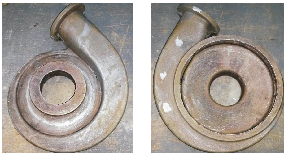
Рисунок 3 – Отливка «Корпус насоса»
