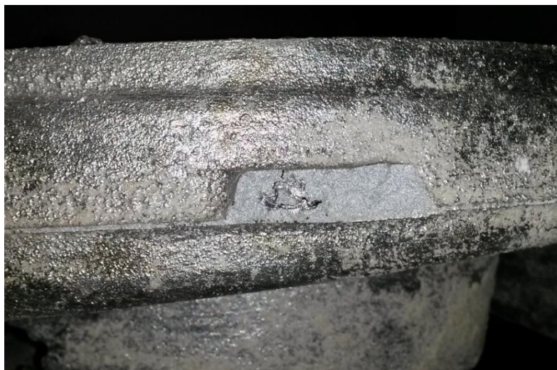
Рисунок 2 – Усадочная пористость в зоне подвода питания.
